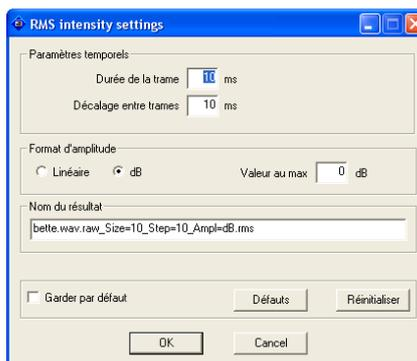
**Paramètres temporels** L'intensité RMS correspond à l'amplitude moyenne d'un signal. Cette mesure est calculée sur une trame de signal dont la longueur est appelée " temps d'intégration ". Une valeur de 10-20 ms est adaptée à la parole, mais dans le cas d'une voix très basse, il est plus judicieux de fixer une valeur plus grande (environ 50 ms).
